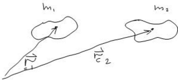
Hvis et system består av  $n$  deler, hvor del med masse  $m_i$  og massesenter  $\vec{r}_{c,i}$  så har systemet totalmasse  $M = \sum_{i=1}^n m_i$  og massesenter  $\vec{r}_c = \frac{1}{M} \sum_{i=1}^n m_i \cdot \vec{r}_{c,i}$ .
