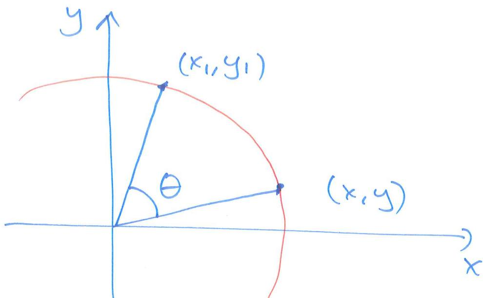
$$\begin{bmatrix} x_1 \\ y_1 \end{bmatrix} = \begin{bmatrix} \cos \theta & -\sin \theta \\ \sin \theta & \cos \theta \end{bmatrix} \begin{bmatrix} x \\ y \end{bmatrix}$$
